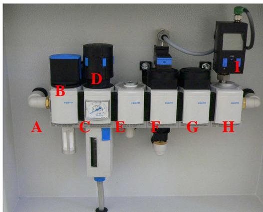
Se è previsto un impianto pneumatico, la pressione dell'aria deve essere compresa tra i 5 e i 6 bar (tra 0.5 e 0.6MPa). L'aria della rete di alimentazione deve essere il più possibile priva di impurità (umidità, particolati).
